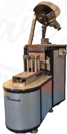
Figura 7. Máquina empacadora de munición para calibre 9 mm Fuente: Elaboración propia – Gerencia Fábrica Fagecor
