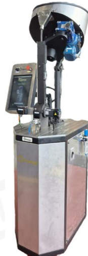
Figura 8. Máquina seleccionadora de lotes para calibre 5.56 mm Fuente: Elaboración propia – Gerencia Fábrica Fagecor
