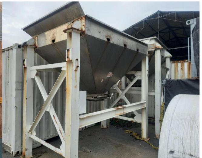
*Imagen 14. Tolvas Acero Inox y Tanques Acero Inox.*
