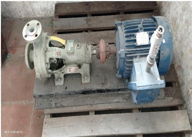
**Imagen 8. Bomba Centrífuga Acero Inox.**
