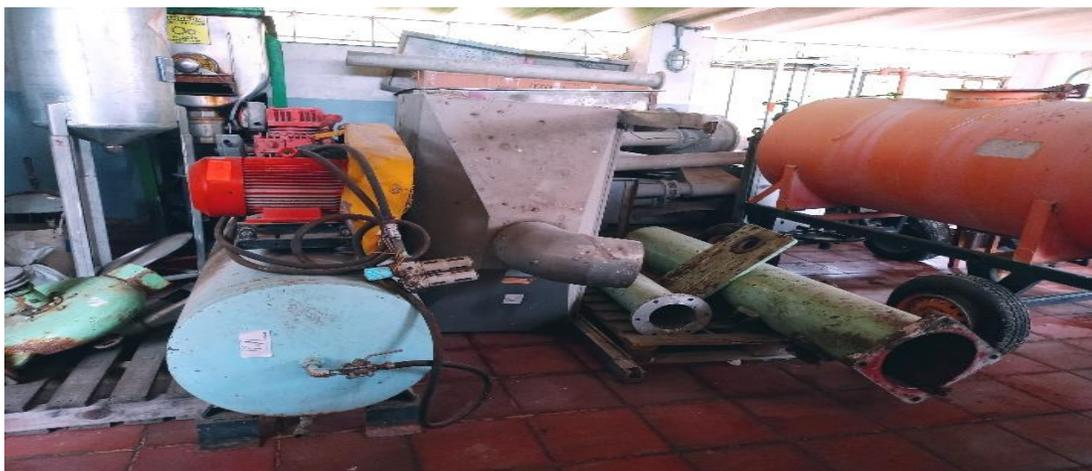
*Imagen 6. Tanque de Dosificación, Molino Y Presurizador Bidones.*
