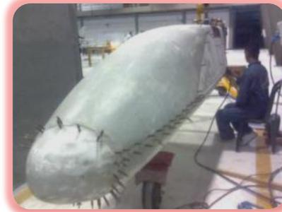
Figura No. 2- 90. Fabricación Prototipo UAV
