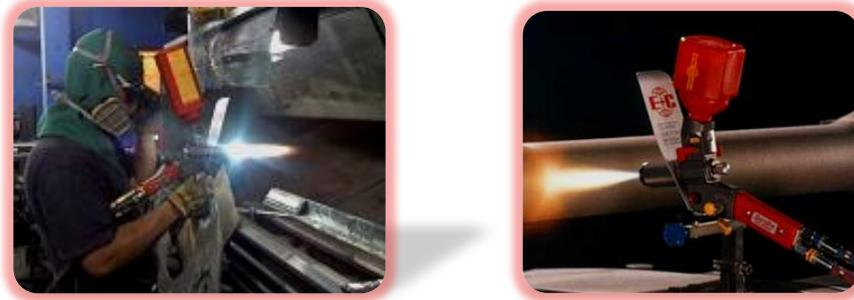
Figura No. 2- 86. Proceso de proyección térmica
