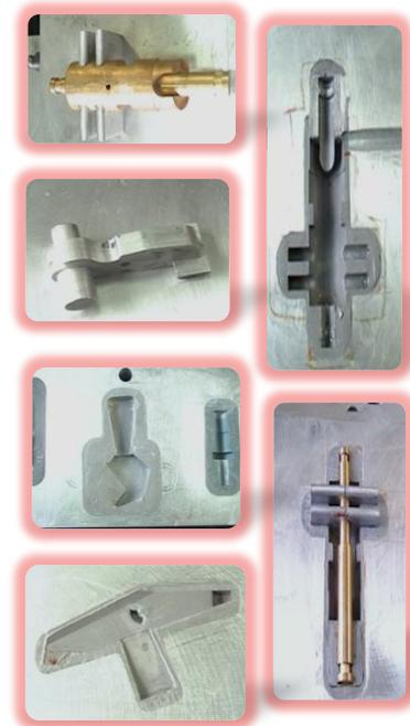
Figura No. 2- 39. Componentes para Fusil Ace 7.62
