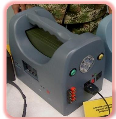
**Figura No. 2- 83. Unidad Generadora de Energía**
