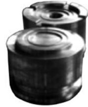
Utillaje proceso de forja King Pin
