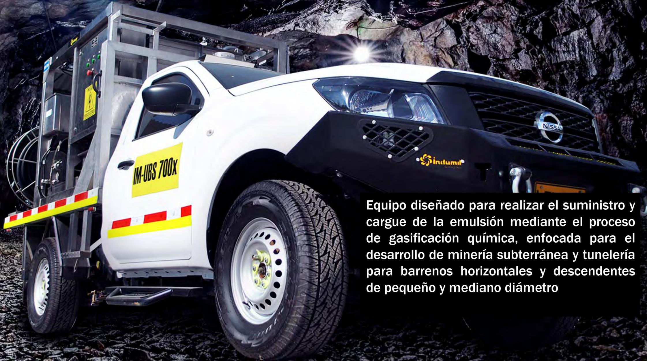
Equipo diseñado para realizar el suministro y cargue de la emulsión mediante el proceso de gasificación química, enfocada para el desarrollo de minería subterránea y tunelería para barrenos horizontales y descendentes de pequeño y mediano diámetro
